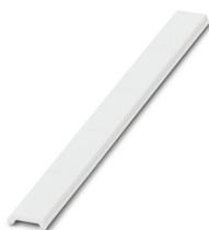
Ruban de repérage ZB, plat, à commander : par bandes, blanc, impression selon les indications du client, type de montage: encliquetage dans la rainure de repérage plate, pour bloc de jonction au pas de : 15 mm, surface utile: 5,15 x 15,1 mm, Nombre d'étiquettes: 5
