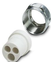
Presse-étoupe métallique multiple Pg16, composé d'un joint d'étanchéité caoutchouc avec plusieurs trous (2 x 6 mm / 1 x 7 mm) et d'une vis de pression, pour manchons pour presse-étoupe VC-M-KV-PG16...
