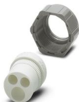
Demi-connexion vissée Pg21 en plastique, composée d'un joint d'étanchéité caoutchouc avec plusieurs trous (2 x 7,2 mm / 1 x 10,5 mm) et d'une vis de pression, pour manchons pour presse-étoupe VC-M-KV-PG21.....
