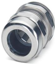
Presse-étoupe, matériau du raccordement vissé: Laiton, nickelé, diamètre extérieur du câble 9 mm ... 13 mm, blindage: oui, filetage de raccordement: M20 x 1,5, coloris: argenté, avec joint torique
