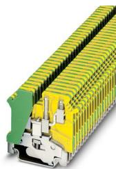
Bloc de jonction pour conducteur de protection à 1 niveau avec raccordement double asymétrique, section transversale : 0,2 - 2,5 mm<sup>2</sup>, largeur : 5,2 mm, coloris : vert-jaune
