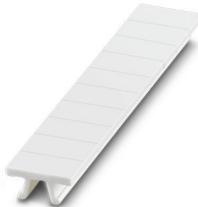
Ruban de repérage ZB, à commander : par bandes, blanc, impression selon les indications du client, type de montage: encliquetage dans la rainure de repérage élevée, pour bloc de jonction au pas de : 5,2 mm, surface utile: 5,15 x 10,5 mm, Nombre d'étiquettes: 10
