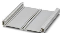
Boîtier pour profilé extrudé, Verrouillage avec les éléments latéraux, verrouillage avec le socle, Profil de base, coloris: gris clair (7035), longueur de profilé (configurable) : 3 cm ... 200 cm, profondeur: 19,8 mm, Remarque : longueur de profilé nécessaire = longueur du circuit imprimé - 16,2 mm
