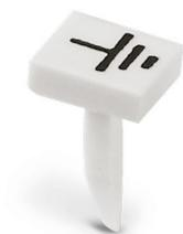
Ergot de repérage, Pointe, blanc, repéré, longitudinal: Symboles +, -, /, ~, ERD, SERD, L1, L2, L3, PE, PEN (jusqu'à 3 emplacements), type de montage: enfichage, pour bloc de jonction au pas de : 4,2 mm, surface utile: 4 x 4 mm, Nombre d'étiquettes: 1
