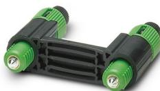
Le système de fixation rapide du transformateur permet de monter en un clin d'œil des transformateurs de courant PACT sur les barres d'alimentation. L'installation se fait simplement à la force des doigts, sans le moindre outil. Pointes de fixation : 40 mm, poche : 13 mm
