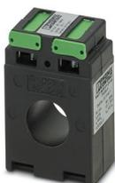
Transformateur de courant à canon, courant primaire 75 A AC, courant secondaire 5 A AC ; classe de précision 1 ; puissance assignée 2,5 VA
