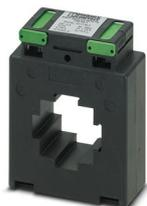
Transformateur de courant enfichable, courant primaire 750 A AC, courant secondaire 5 A AC ; classe de précision 1 ; puissance assignée 10 VA
