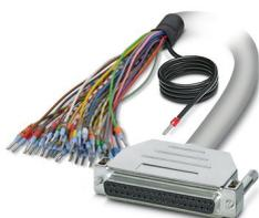
Câble rond blindé préconfectionné; raccordement 1 : Fils individuels (37-pôles) (Les fils sont repérés et équipés d'embouts. La tresse de blindage sort d'une extrémité de câble distincte.); raccordement 2 : Connecteur femelle D-SUB (1x 37-pôles); longueur de câble: 20 m
