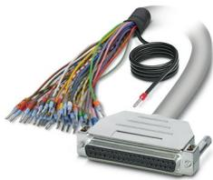
Câble rond blindé préconfectionné; raccordement 1 : Fils individuels (37-pôles) (Les fils sont repérés et équipés d'embouts. La tresse de blindage sort d'une extrémité de câble distincte.); raccordement 2 : Connecteur femelle D-SUB (1x 37-pôles); longueur de câble: 10 m
