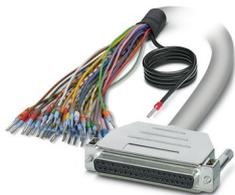
Câble rond blindé préconfectionné; raccordement 1 : Fils individuels (37-pôles) (Les fils sont repérés et équipés d'embouts. La tresse de blindage sort d'une extrémité de câble distincte.); raccordement 2 : Connecteur femelle D-SUB (1x 37-pôles); longueur de câble: 3 m
