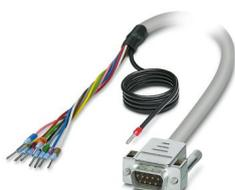
Câble rond blindé préconfectionné; raccordement 1 : Fils individuels (9-pôles) (Les fils sont repérés et équipés d'embouts. La tresse de blindage sort d'une extrémité de câble distincte.); raccordement 2 : Connecteur mâle D-SUB (1x 9-pôles); longueur de câble: 1,5 m
