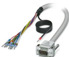
Câble rond blindé préconfectionné; raccordement 1 : Fils individuels (9-pôles) (Les fils sont repérés et équipés d'embouts. La tresse de blindage sort d'une extrémité de câble distincte.); raccordement 2 : Connecteur mâle D-SUB (1x 9-pôles); longueur de câble: 2 m
