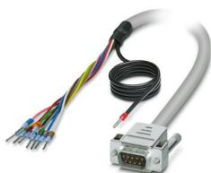
Câble rond blindé préconfectionné; raccordement 1 : Fils individuels (9-pôles) (Les fils sont repérés et équipés d'embouts. La tresse de blindage sort d'une extrémité de câble distincte.); raccordement 2 : Connecteur mâle D-SUB (1x 9-pôles); longueur de câble: variable
