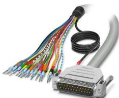
Câble rond blindé préconfectionné; raccordement 1 : Fils individuels (25-pôles) (Les fils sont repérés et équipés d'embouts. La tresse de blindage sort d'une extrémité de câble distincte.); raccordement 2 : Connecteur mâle D-SUB (1x 25-pôles); longueur de câble: 3 m
