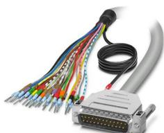
Câble rond blindé préconfectionné; raccordement 1 : Fils individuels (25-pôles) (Les fils sont repérés et équipés d'embouts. La tresse de blindage sort d'une extrémité de câble distincte.); raccordement 2 : Connecteur mâle D-SUB (1x 25-pôles); longueur de câble: 0,5 m
