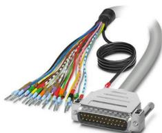
Câble rond blindé préconfectionné; raccordement 1 : Fils individuels (25-pôles) (Les fils sont repérés et équipés d'embouts. La tresse de blindage sort d'une extrémité de câble distincte.); raccordement 2 : Connecteur mâle D-SUB (1x 25-pôles); longueur de câble: 1,5 m
