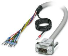
Câble rond blindé préconfectionné; raccordement 1 : Fils individuels (9-pôles) (Les fils sont repérés et équipés d'embouts. La tresse de blindage sort d'une extrémité de câble distincte.); raccordement 2 : Connecteur mâle D-SUB (1x 9-pôles); longueur de câble: 4 m
