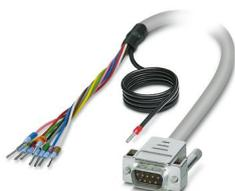
Câble rond blindé préconfectionné; raccordement 1 : Fils individuels (9-pôles) (Les fils sont repérés et équipés d'embouts. La tresse de blindage sort d'une extrémité de câble distincte.); raccordement 2 : Connecteur mâle D-SUB (1x 9-pôles); longueur de câble: 1 m
