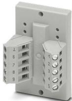
Le module d'exécution VARIOFACE réalise une liaison 1:1 entre des blocs de jonction à vis et un connecteur femelle D-SUB miniature (9 pôles). Une dérivation à la masse distincte est disponible.
