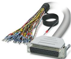
Câble rond blindé préconfectionné; raccordement 1 : Fils individuels (50-pôles) (Les fils sont repérés et équipés d'embouts. La tresse de blindage sort d'une extrémité de câble distincte.); raccordement 2 : Connecteur femelle D-SUB (1x 50-pôles); longueur de câble: 1,5 m
