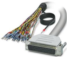
Câble rond blindé préconfectionné; raccordement 1 : Fils individuels (50-pôles) (Les fils sont repérés et équipés d'embouts. La tresse de blindage sort d'une extrémité de câble distincte.); raccordement 2 : Connecteur femelle D-SUB (1x 50-pôles); longueur de câble: 4 m
