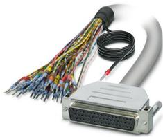
Câble rond blindé préconfectionné; raccordement 1 : Fils individuels (50-pôles) (Les fils sont repérés et équipés d'embouts. La tresse de blindage sort d'une extrémité de câble distincte.); raccordement 2 : Connecteur femelle D-SUB (1x 50-pôles); longueur de câble: 1 m
