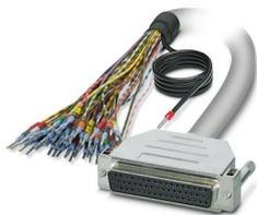
Câble rond blindé préconfectionné; raccordement 1 : Fils individuels (50-pôles) (Les fils sont repérés et équipés d'embouts. La tresse de blindage sort d'une extrémité de câble distincte.); raccordement 2 : Connecteur femelle D-SUB (1x 50-pôles); longueur de câble: 0,5 m
