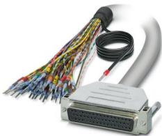
Câble rond blindé préconfectionné; raccordement 1 : Fils individuels (50-pôles) (Les fils sont repérés et équipés d'embouts. La tresse de blindage sort d'une extrémité de câble distincte.); raccordement 2 : Connecteur femelle D-SUB (1x 50-pôles); longueur de câble: 6 m
