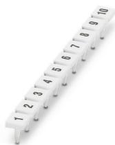
Ruban Zack de picots de repérage, Rubans, blanc, repéré, impression longitudinale: numérotation continue 1 ... 10, 11 ... 20, etc. jusqu'à 491 ... 500, type de montage: enfichage, pour bloc de jonction au pas de : 5 mm, surface utile: 4 x 4 mm, Nombre d'étiquettes: 10
