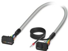
Câble rond blindé préconfectionné; raccordement 1 : IDC/FLK connecteur femelle (1x 14-pôles); raccordement 2 : IDC/FLK connecteur femelle (1x 14-pôles) (La tresse de blindage sort d'une extrémité de câble distincte.); longueur de câble: 1,5 m
