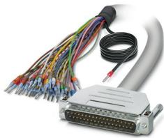
Câble rond blindé préconfectionné; raccordement 1 : Fils individuels (37-pôles) (Les fils sont repérés et équipés d'embouts. La tresse de blindage sort d'une extrémité de câble distincte.); raccordement 2 : Connecteur mâle D-SUB (1x 37-pôles); longueur de câble: 3 m
