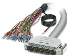
Câble rond blindé préconfectionné; raccordement 1 : Fils individuels (37-pôles) (Les fils sont repérés et équipés d'embouts. La tresse de blindage sort d'une extrémité de câble distincte.); raccordement 2 : Connecteur mâle D-SUB (1x 37-pôles); longueur de câble: variable
