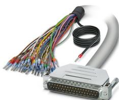
Câble rond blindé préconfectionné; raccordement 1 : Fils individuels (37-pôles) (Les fils sont repérés et équipés d'embouts. La tresse de blindage sort d'une extrémité de câble distincte.); raccordement 2 : Connecteur mâle D-SUB (1x 37-pôles); longueur de câble: 6 m
