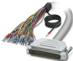
Câble rond blindé préconfectionné; raccordement 1 : Fils individuels (37-pôles) (Les fils sont repérés et équipés d'embouts. La tresse de blindage sort d'une extrémité de câble distincte.); raccordement 2 : Connecteur mâle D-SUB (1x 37-pôles); longueur de câble: 2 m
