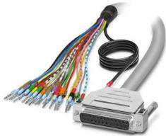
Câble rond blindé préconfectionné; raccordement 1 : Fils individuels (25-pôles) (Les fils sont repérés et équipés d'embouts. La tresse de blindage sort d'une extrémité de câble distincte.); raccordement 2 : Connecteur femelle D-SUB (1x 25-pôles); longueur de câble: variable
