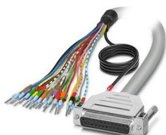
Câble rond blindé préconfectionné; raccordement 1 : Fils individuels (25-pôles) (Les fils sont repérés et équipés d'embouts. La tresse de blindage sort d'une extrémité de câble distincte.); raccordement 2 : Connecteur femelle D-SUB (1x 25-pôles); longueur de câble: 0,5 m
