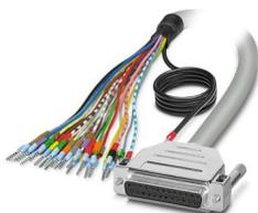
Câble rond blindé préconfectionné; raccordement 1 : Fils individuels (25-pôles) (Les fils sont repérés et équipés d'embouts. La tresse de blindage sort d'une extrémité de câble distincte.); raccordement 2 : Connecteur femelle D-SUB (1x 25-pôles); longueur de câble: 6 m
