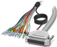
Câble rond blindé préconfectionné; raccordement 1 : Fils individuels (25-pôles) (Les fils sont repérés et équipés d'embouts. La tresse de blindage sort d'une extrémité de câble distincte.); raccordement 2 : Connecteur femelle D-SUB (1x 25-pôles); longueur de câble: 20 m
