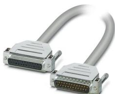
Câble rond prééquipé, blindé, exempt d'halogène; raccordement 1 : Connecteur femelle D-SUB (1x 25-pôles); raccordement 2 : Connecteur mâle D-SUB (1x 25-pôles); longueur de câble: 1 m
