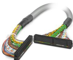
Câble rond prééquipé, exempt d'halogène; raccordement 1 : IDC/FLK connecteur femelle (1x 50-pôles); raccordement 2 : IDC/FLK connecteur femelle (1x 50-pôles); longueur de câble: 5 m
