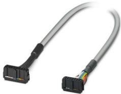
Câble rond prééquipé, exempt d'halogène; automate: SIMATIC® TOP connect; raccordement 1 : IDC/FLK connecteur femelle (1x 16-pôles); raccordement 2 : IDC/FLK connecteur femelle (1x 14-pôles); longueur de câble: 0,5 m
