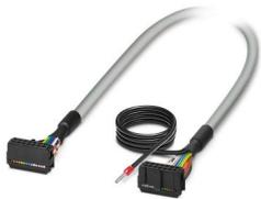
Câble rond blindé préconfectionné; raccordement 1 : IDC/FLK connecteur femelle (1x 14-pôles); raccordement 2 : IDC/FLK connecteur femelle (1x 14-pôles) (La tresse de blindage sort d'une extrémité de câble distincte.); longueur de câble: 8 m
