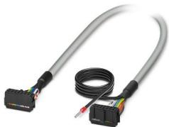
Câble rond blindé préconfectionné; raccordement 1 : IDC/FLK connecteur femelle (1x 14-pôles); raccordement 2 : IDC/FLK connecteur femelle (1x 14-pôles) (La tresse de blindage sort d'une extrémité de câble distincte.); longueur de câble: 10 m
