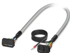
Câble rond blindé préconfectionné; raccordement 1 : IDC/FLK connecteur femelle (1x 14-pôles); raccordement 2 : IDC/FLK connecteur femelle (1x 14-pôles) (La tresse de blindage sort d'une extrémité de câble distincte.); longueur de câble: 6 m
