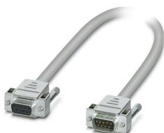
Câble rond prééquipé, blindé, exempt d'halogène; raccordement 1 : Connecteur femelle D-SUB (1x 9-pôles); raccordement 2 : Connecteur mâle D-SUB (1x 9-pôles); longueur de câble: 2 m
