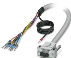
Câble rond blindé préconfectionné; raccordement 1 : Fils individuels (9-pôles) (Les fils sont repérés et équipés d'embouts. La tresse de blindage sort d'une extrémité de câble distincte.); raccordement 2 : Connecteur femelle D-SUB (1x 9-pôles); longueur de câble: 2 m
