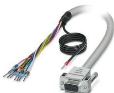
Câble rond blindé préconfectionné; raccordement 1 : Fils individuels (9-pôles) (Les fils sont repérés et équipés d'embouts. La tresse de blindage sort d'une extrémité de câble distincte.); raccordement 2 : Connecteur femelle D-SUB (1x 9-pôles); longueur de câble: variable
