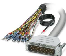
Câble rond blindé préconfectionné; raccordement 1 : Fils individuels (50-pôles) (Les fils sont repérés et équipés d'embouts. La tresse de blindage sort d'une extrémité de câble distincte.); raccordement 2 : Connecteur mâle D-SUB (1x 50-pôles); longueur de câble: 3 m
