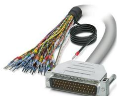
Câble rond blindé préconfectionné; raccordement 1 : Fils individuels (50-pôles) (Les fils sont repérés et équipés d'embouts. La tresse de blindage sort d'une extrémité de câble distincte.); raccordement 2 : Connecteur mâle D-SUB (1x 50-pôles); longueur de câble: 0,5 m
