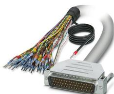
Câble rond blindé préconfectionné; raccordement 1 : Fils individuels (50-pôles) (Les fils sont repérés et équipés d'embouts. La tresse de blindage sort d'une extrémité de câble distincte.); raccordement 2 : Connecteur mâle D-SUB (1x 50-pôles); longueur de câble: 1,5 m
