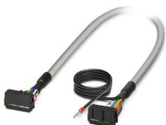
Câble rond blindé préconfectionné; raccordement 1 : IDC/FLK connecteur femelle (1x 14-pôles); raccordement 2 : IDC/FLK connecteur femelle (1x 14-pôles) (La tresse de blindage sort d'une extrémité de câble distincte.); longueur de câble: 1,2 m
