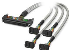
Câble rond pré-équipé; automate: OMRON CJ1 (OD 231, OD 261), CQM1 (OD 213, OD 112), CS1, C200H (OD 218, OD 219); raccordement 1 : Connecteur Fujitsu (1x 40-pôles); raccordement 2 : IDC/FLK connecteur femelle (4x 14-pôles); longueur de câble: 1 m
