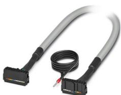
Câble rond blindé préconfectionné; raccordement 1 : IDC/FLK connecteur femelle (1x 16-pôles); raccordement 2 : IDC/FLK connecteur femelle (1x 16-pôles) (La tresse de blindage sort d'une extrémité de câble distincte.); longueur de câble: 4 m
