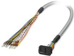
Câble rond pré-équipé; raccordement 1 : Fils individuels (14-pôles) (Les fils sont repérés et équipés d'embouts); raccordement 2 : IDC/FLK connecteur femelle (1x 14-pôles); longueur de câble: 2 m
