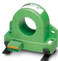
Convertisseur de courant universel, pour mesurer des courants continus, alternatifs ou déformés, courant d'entrée de 0 à 100 A, courant de sortie de 4 à 20 mA
