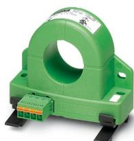
Convertisseur de courant universel, pour mesurer des courants continus, alternatifs ou déformés, un courant d'entrée de 0 à 200 A, un courant de sortie de 4 à 20 mA
