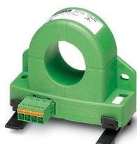
Transformateur universel de mesure de courant, pour la mesure de courants continus, alternatifs et déformés, intensité de courant d'entrée de 0 à 600 A, courant de sortie de 4 à 20 mA
