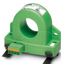
Transformateur universel de mesure de courant, pour la mesure de courants continus, alternatifs et déformés, intensité de courant d'entrée de 0 à 200 A, tension de sortie de 0 à 10 V
