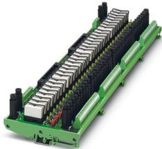
Module à relais d'entrée à 32 voies (1 contact NO) à raccordement vissé et avec fusible (1 A). Raccordement d'E/S redondant de l'alimentation en tension et du connecteur 50 pôles. Compatible avec les cartes Yokogawa ADV151 et ADV161.
