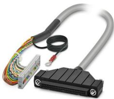
Câble rond blindé préconfectionné; automate: Yokogawa CS3000 CentumVP (ADV561, ADV161); raccordement 1 : IDC/FLK connecteur femelle (1x 50-pôles); raccordement 2 : Yokogawa, compatible KS (1x 50-pôles); longueur de câble: 15 m
