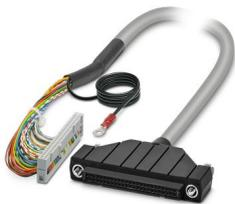
Câble rond blindé préconfectionné; automate: Yokogawa CS3000 CentumVP (ADV561, ADV161); raccordement 1 : IDC/FLK connecteur femelle (1x 50-pôles); raccordement 2 : Yokogawa, compatible KS (1x 50-pôles); longueur de câble: 30 m
