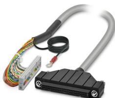
Câble rond blindé préconfectionné; automate: Yokogawa CS3000 CentumVP (ADV561, ADV161); raccordement 1 : IDC/FLK connecteur femelle (1x 50-pôles); raccordement 2 : Yokogawa, compatible KS (1x 50-pôles); longueur de câble: 3 m
