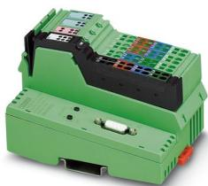
Inline, Coupleur de bus, Modbus/RTU, Connecteur femelle SUB-D 9, Entrées TOR: 8, 24 V DC, connectique: 3 fils, Sorties TOR: 4, 24 V DC, 500 mA, connectique: 3 fils, vitesse de transmission dans le bus local: 500 kBit/s / 2 MBit/s, indice de protection: IP20, Y compris connecteurs Inline, champs de repérage et plaque terminale
