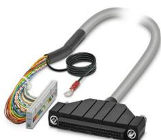
Câble rond blindé préconfectionné; automate: Yokogawa CS3000 CentumVP (ADV561, ADV161); raccordement 1 : IDC/FLK connecteur femelle (1x 50-pôles); raccordement 2 : Yokogawa, compatible KS (1x 50-pôles); longueur de câble: 10 m
