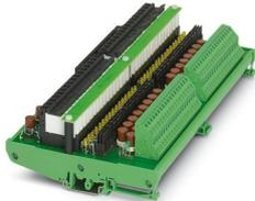
Module à relais d'entrée à 32 canaux à raccordement à ressort et connexion système 50 pôles. Le côté excitation est protégé et, en option, non isolé galvaniquement. Adapté pour les cartes Yokogawa ADV 151 et ADV 161.
