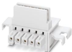
Connecteurs sur profilé, coloris: gris clair, intensité nominale: 8 A (contacts parallèles), tension de référence (III/2): 125 V, nombre de pôles: 5, pas: 3,81 mm, montage: Montage sur profilé, verrouillage: sans, type de fixation: sans, type de conditionnement: emballé dans un carton, Article avec contacts dorés, connecteur de bus pour le raccordement de boîtiers électroniques, 5 contacts parallèles
