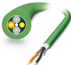
Câble d'installation PCF-PROFINET à confectionner (uniquement têtes IP20) pour le câblage dans des installations et machines fixes, éléments individuels en polyamide (PA), résistant à l'ozone et aux UV, avec gaine extérieure en PVC
