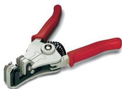
Pince à dénuder pour décaler les éléments individuels du câble FO. Convient parfaitement aux câbles polymères et PCF. Une mécanique spéciale et des formes de lame précises permettent d'éviter d'endommager la fibre optique. Dimensions : (L x l x H) 160 x 130 x 36 mm
