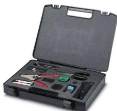
Kit de confection de câbles HCS pour connecteur B-FOC(ST) à montage rapide comprenant un couteau et une pince à dénuder, des ciseaux pour fil aramide, une pince à fibre, un microscope, un outil à entailler les fibres HCS standard et les fibres HCS-GI, quatre connecteurs mâles B-FOC(ST) pour fibres HCS standard ainsi que la documentation
