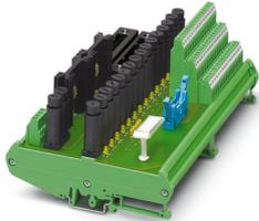
Module analogique de 16 canaux à raccordement vissé et un fusible par chemin de signal (5x20 mm) avec voyant de défaillance (LED). Réalisation redondante de l'alimentation en tension et de la connexion système à 40 pôles. Adapté pour les cartes Yokogawa AAI141 et AAI143.
