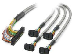
Câble rond pré-équipé; raccordement 1 : IDC/FLK connecteur femelle (1x 50-pôles); raccordement 2 : IDC/FLK connecteur femelle (4x 14-pôles); longueur de câble: 0,5 m
