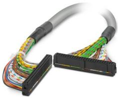
Câble rond pré-équipé; raccordement 1 : IDC/FLK connecteur femelle (1x 50-pôles); raccordement 2 : IDC/FLK connecteur femelle (1x 50-pôles); longueur de câble: 8,5 m
