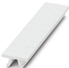
Ruban de repérage ZB, Rubans, blanc, vierge, repérable avec : PLOTMARK, CMS-P1-PLOTTER, type de montage: encliquetage, pour bloc de jonction au pas de : 5,08 mm, surface utile: 4,98 x 10,5 mm, Nombre d'étiquettes: 10
