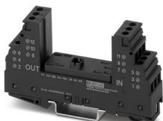
Embase pour fiche de protection PT avec circuit de protection pour un circuit de signal à 4 fils sans potentiel de terre, éclateur à gaz entre les connexion 3-4 (GND) et 9-10, montage sur NS 35/7,5 et NS 35/15, largeur de boîtier : 17,5 mm
