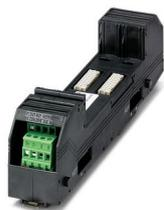
Embase pour connecteur d'alimentation de bus de terrain. Redondance assurée lorsque 2 connecteurs sont installés. La redondance est maintenue à l'aide des bus d'alimentation internes par le biais de plusieurs embases. Un autre bus interne permet la signalisation à distance.
