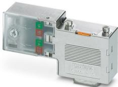
Connecteur mâle D-SUB, 9 pôles, picot, arrivée axiale du câble à 90°, système de bus : PROFIBUS DP jusqu'à 12 MBit/s, résistance de terminaison connectable via commutateur coulissant, brochage : 3, 5, 6, 8 ; blocs de jonction à vis
