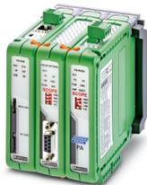
Système de couplage PROFIBUS DP - PROFIBUS PA pour l'intégration et le diagnostic de PROFIBUS PA dans un PROFIBUS DP. Comprend une unité de tête de station (FB-HSB), un répéteur PROFIBUS DP avec oscilloscope (FB-DP-RPTR/SC) et un module interface PROFIBUS PA avec oscilloscope.
