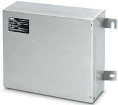
Coffret de commande de terrain, en acier inoxydable, à 16 raccordements, destiné aux zones Ex. Contient un bloc coupleur d'appareils 12 voies (FB-12SP) pour Foundation Fieldbus ou PROFIBUS PA et trois blocs de jonction pour le câblage principal (+, -, S).
