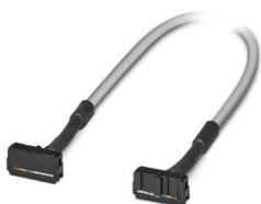
Câble rond pré-équipé; raccordement 1 : IDC/FLK connecteur femelle (1x 16-pôles); raccordement 2 : IDC/FLK connecteur femelle (1x 16-pôles); longueur de câble: 1,5 m
