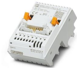
Huit amplificateurs-séparateurs MINI Analog Pro et convertisseurs de mesure peuvent être raccordés à un automate, à l'aide d'adaptateurs-système et de système de pré-câblage, sans câblage fastidieux et sans aucune erreur.
