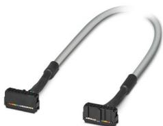
Câble rond pré-équipé; raccordement 1 : IDC/FLK connecteur femelle (1x 16-pôles); raccordement 2 : IDC/FLK connecteur femelle (1x 16-pôles); longueur de câble: 10 m
