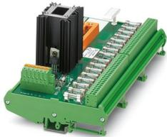
Module d'entrées analogique à 16 canaux à raccordement à ressort et alimentation en tension redondante. Adapté pour la carte Yokogawa SAI 143.
