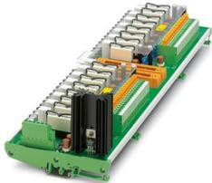
Module à relais de sortie à 16 canaux avec raccordement vissé et connexion système à 50 pôles, le côté excitation est protégé et éventuellement relié au potentiel, pour carte Yokogawa SDV 541, largeur de module : 425 mm
