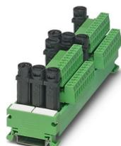
Module porte-fusibles, avec raccordement vissé, connecteurs mâles MINICONNEC avec rehausse et détrompage pour éviter les erreurs d'enfichage, pour montage sur NS 35/7,5 ou NS 32
