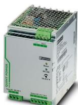
Alimentation à découpage primaire QUINT POWER, Raccordement vissé, Montage sur profilé, SFB Technology (Selective Fuse Breaking), entrée: 1 phasée, sortie : 24 V DC / 20 A
