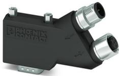
Connecteur D-SUB, 9 pôles, tige, affectation : 3, 5, 6, 8 ; deux presse-étoupes M12 (détrompage B) à 35°. Système de bus : PROFIBUS DP jusque 12 MBit/s. Résistance de terminaison sur terminateur M12 séparé.
