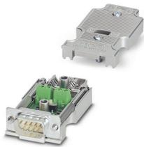
Connecteur mâle D-SUB , 9 pôles, modèle axial avec deux arrivées de câble, système de bus : PROFIBUS DP jusqu'à 12 MBit/s, résistance de terminaison connectable via commutateur coulissant, brochage : 3, 5, 6, 8 ; blocs de jonction à vis
