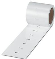
Etiquette, pour le marquage des modules Axioline de Phoenix Contact, Rouleau, blanc, vierge, repérable avec : THERMOMARK E.300 (D)/600 (D), THERMOMARK ROLL 2.0, THERMOMARK ROLL, THERMOMARK ROLL X1, THERMOMARK ROLLMASTER 300/600, THERMOMARK X1.2, type de montage: insertion, surface utile: 35 x 18,7 mm, Nombre d'étiquettes: 500
